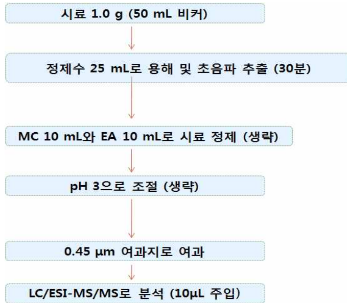
그림 5. LC-MS/MS에 의한 유기산의 분석 절차
