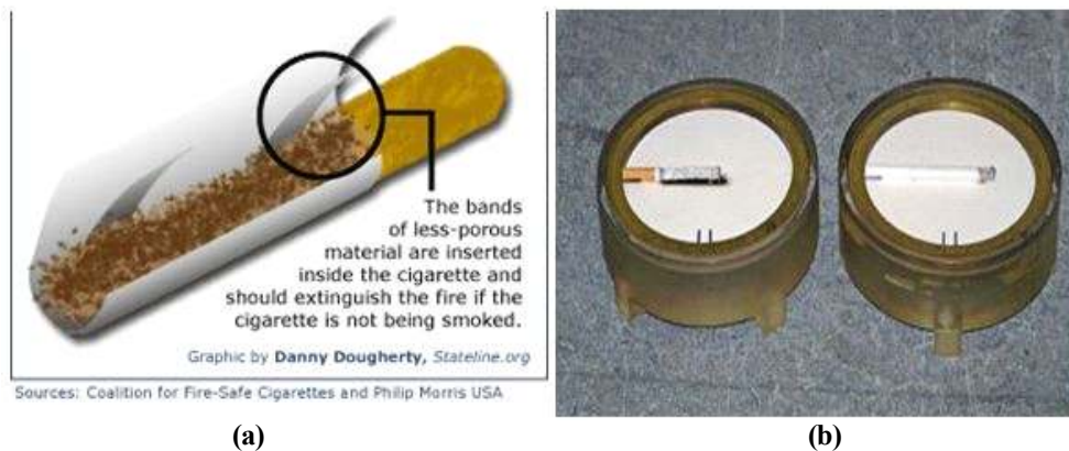
그림 1. (a) 화재표준준수담배의 기본원리와 (b) 담배의 점화강도 평가방법
