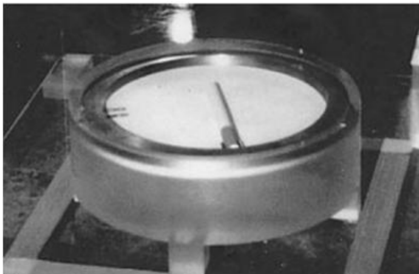
그림 2. 시험 담배와 필터종이 홀더, 금속핀 및 금속테두리 사진
