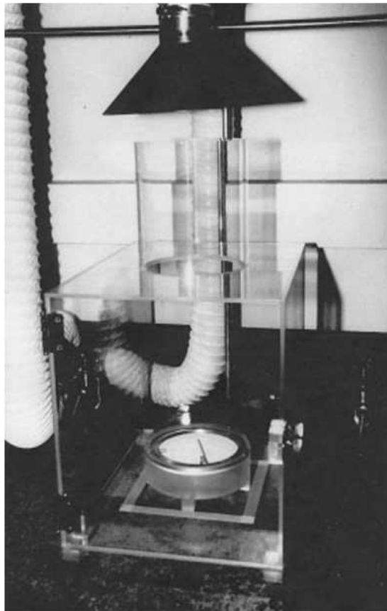
그림 1. 필터 종이 홀더와 시험 챔버 사진
